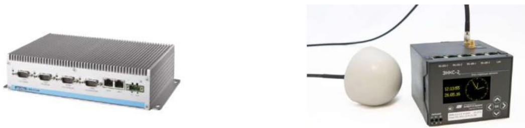
АИИС КУЭ представляют собой сложные иерархические системы, в которых важное значение имеют устройства сбора и передачи данных (УСПД), обеспечивающие сбор и хранение данных со счетчиков электроэнергии и других приборов учета ресурсов. УСПД устанавливаются как непосредственно в электроустановках, так и в центрах сбора и обработки данных.
